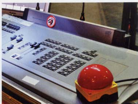
Poste de commande avec arrêt d'urgence ; bouton "homme mort" dans la main de l'opérateur
