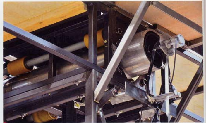
Capteur absolu placé dans l'axe au centre de l'objet
