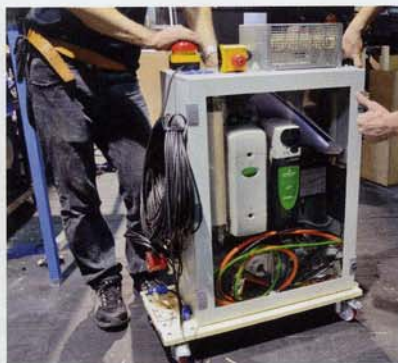
Armoire de commande équipée de l'Unidrive Emerson Leroy Somer et la carte 2 e Solution
