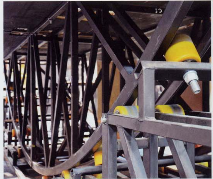
Détail du guidage, galets latéraux et horizontaux
